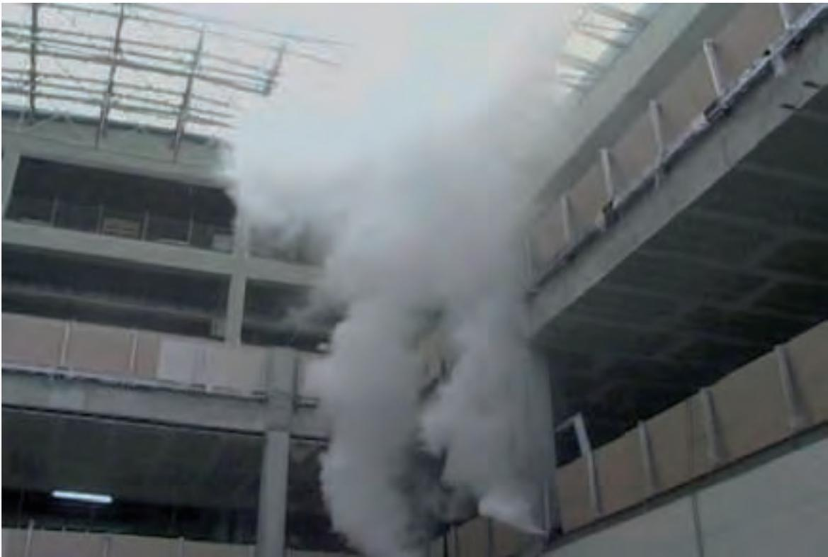
Abbildung 42: Entrauchungsversuch zur Verbesserung des Brandschutzes
